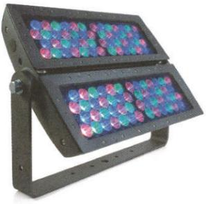
高出力のフルカラーLED投光器。最長照射距離が200mのため、タワー、橋、スタジアムなどの大規模建造物の演出に適している。今年6月のアップグレードにより最大光度が21%向上(配光5度、拡散レンズ無しの場合)。消費電力250W。屋外使用可能。拡散レンズ(別売品)は6種類。
